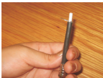
Figura 4: Retirar la protección de plástico.
