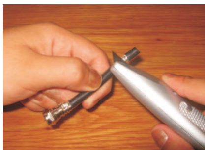
Figura 3: Cortar totalmente un extremo del cable coaxial.
