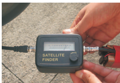
Figura 15: Calibrar el Buscador de Satélites para evitar contaminación de ruido en la señal de interés.
