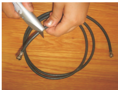
Figura 3: Cortar totalmente un extremo del cable coaxial.
