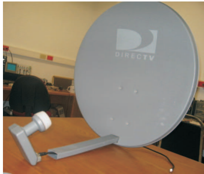
Figura 12: Adaptar el LNB a la antena.
