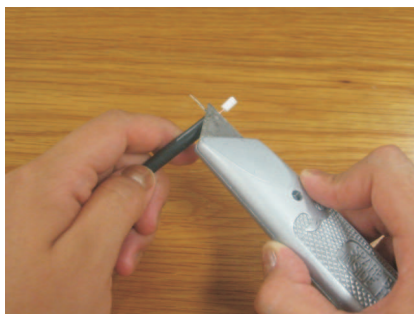
Figura 6: Desprender el aislante (plástico blanco).
